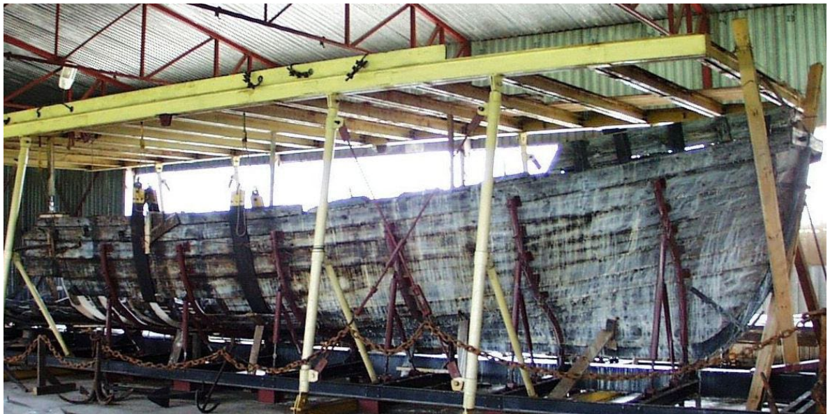
Рис. 2. Козацька “чайка” на тимчасовому стапелі. Перший етап консерваційних робіт. Просочення ПЕГ 4000.
