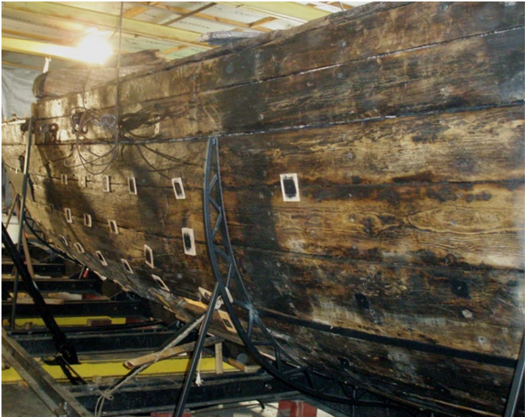
Рис. 3. Козацька “чайка” на стаціонарному стапелі. Стан деревини після другого етапу консервації.
