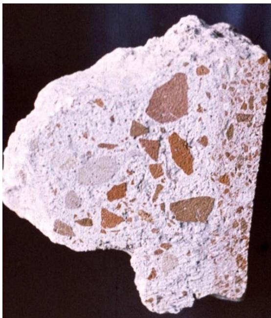
Фото 6. Золоті Ворота. Макроструктура вапняно-цем'янкового розчину XI ст. Товща мурувального розчину з тонким шаром опоряджувального тиньку.
