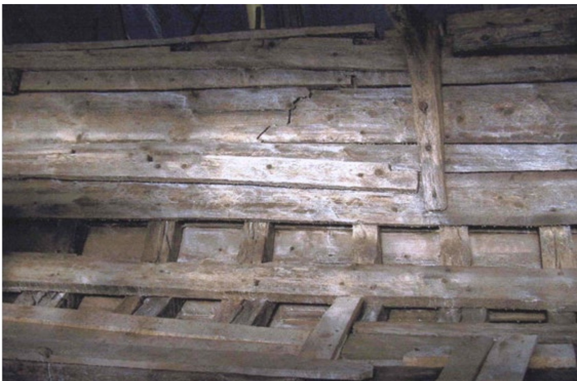
Рис. 4. Козацька “чайка”. Внутрішні конструкції та обшивка. Стан деревини після другого етапу консервації.
