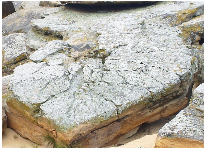
Фото 7. Руйнування поверхні каменю під суцільним шаром лишайників
