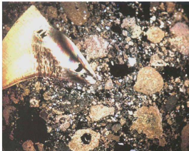
Фото 5. Мікроструктура вапняно-карбонатного розчину з крихтою органогенного оолітового вапняку
